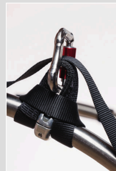
À gauche, les mousquetons de l'aile avec la principale bague de réglage pour l'équilibrage de l'ensemble. À droite, l'accrochage côté pilote.
